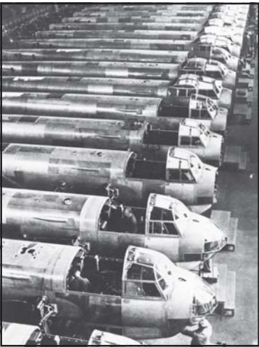
Поточна линия за бомбардировачи “Юнкерс-88”, 1941 година
