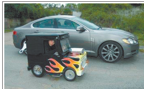
Британският конструктор Пери Уоткинс е съзателят на миниатюрния автомобил. Той е записан в книгата на Гинес като най-малката кола в света с разрешително за пътуване по улиците. Тя развива скорост до 60 км/ч и дори има предпазен колан за шофьора. Размерите ѝ са 1.4 м на 1.29 м, а широчината е 66 см
