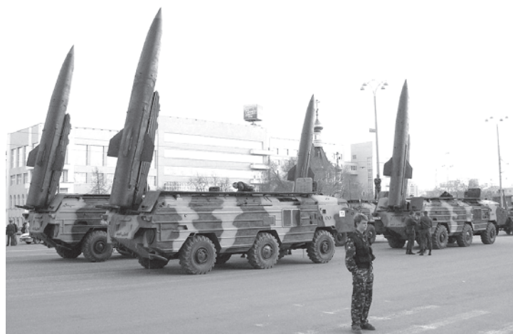
Високомобилният оперативно-тактически ракетен комплекс „Точка-У“ може да бъде оборудван с ракети с обхват на полета от 15 до 129 километра. Стартовата маса на ракетата е 2010 килограма. Бойните части са осем вида. В това число ядрили и снабдени с бойни отравлящи средства - сега вече не на въоръжение. Бойната глава, оборудвана с обикновена фузасна бойна част с маса 482 кг, е способна да даде при експлозия 14 500 парчета, поразявайки всичко живо на територия от 3 хектара. Касетъчната бойна глава осигурява поражение на леко бронирана техника и жива сила на територия от 7 хектара
